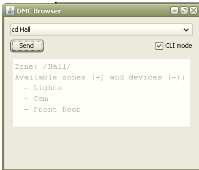
Kuva 2. Käyttäjä on siirtynyt eteiseen (Hall) komennolla cd Hall ja näkee listauksen huoneessa olevista laitteista.
